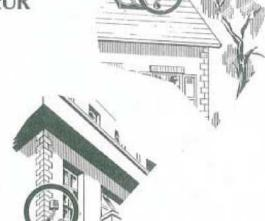
Le déperditeur, appareil simple, d'une pose facile et d'un prix modique, est à lui seul un petit immeuble témoin équivalent thermiquement au bâtiment à contrôler.
